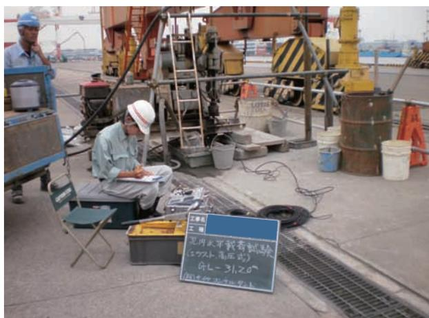
写真-2 孔内水平載荷試験状況
