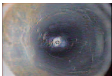
図4 岩盤ボーリング孔壁状況と湧水
