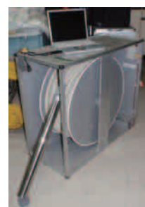
図2 簡易型ボアホールカメラの撮影方法 (簡易型ボアホールカメラ技術パンフレットより)
