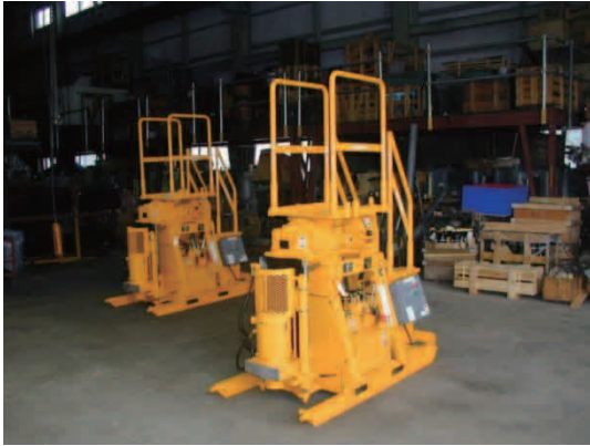
写真 1 作業足場・手すり装着例
