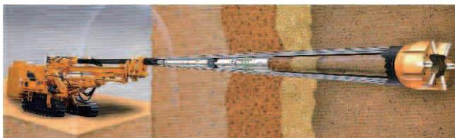
図-3 PS-WL 工法の掘進イメージ
