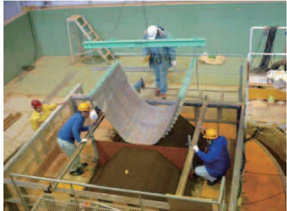
(a) 堤防の液状化対策の大型振動台実験
