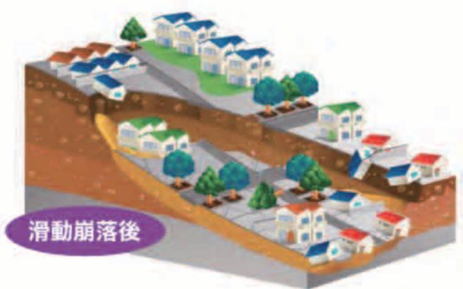
図1 造成地の滑動崩落のイメージ
