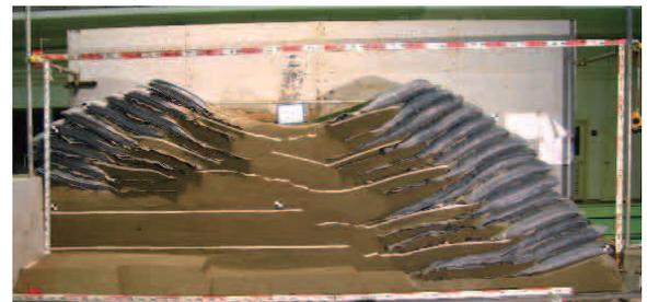
図 2 特殊形状大型土嚢を用いたため池堤体の振動実験（高さ 3 m）
