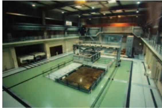
図 5 三次元振動実験施設（振動台 6 × 4 m）
