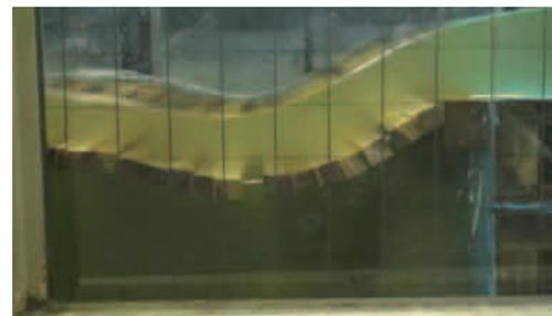
図10 装置を設置したときの流れ (落差構造物の直下流 (装置あり))
