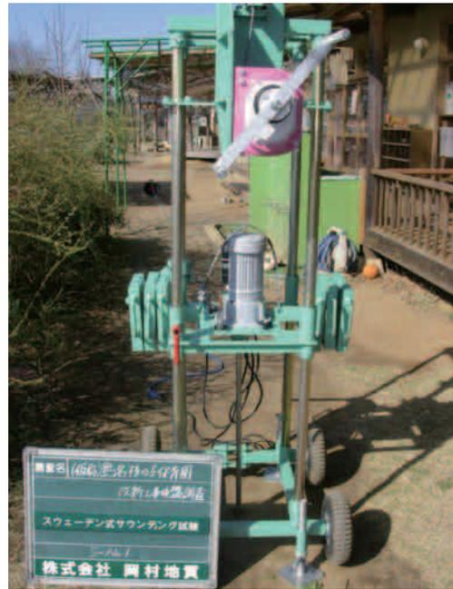
写真-3 スウェーデン式サウンディング試験
