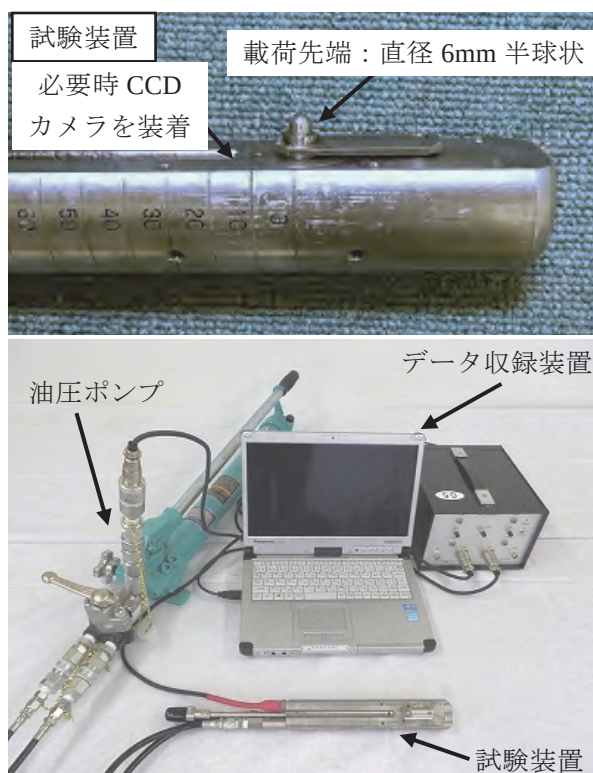
図－1 孔内局部載荷試験装置
