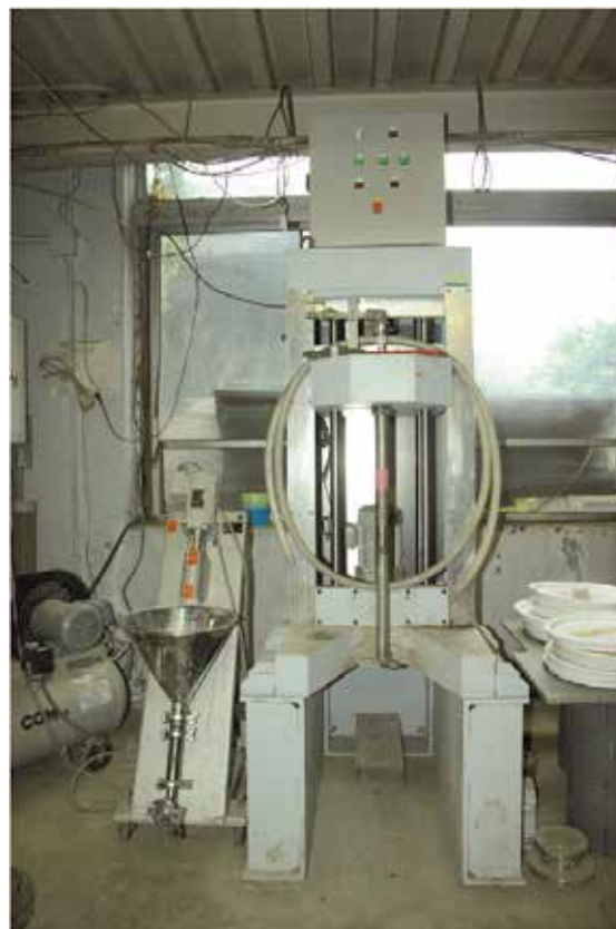
写真-8 地盤改良実験装置
