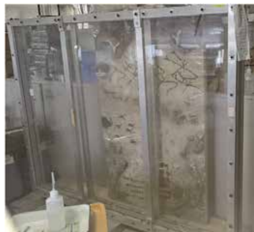
写真－6 大型平面土槽
