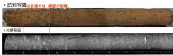
写真-4 礫を多く含む不均質な礫質土
