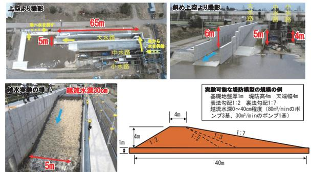
図-4 大規模堤防模型実験水路
