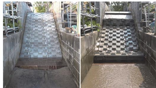
(a) 越流水深20cmで通水した後の裏法部の状況 (b) 滑動し折れ曲がった連節ブロック
