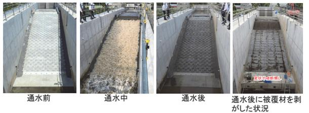
図-9 越水実験状況
